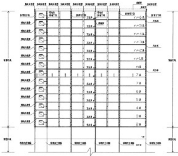
图 10 装配式住宅防雷接地系统示意图
